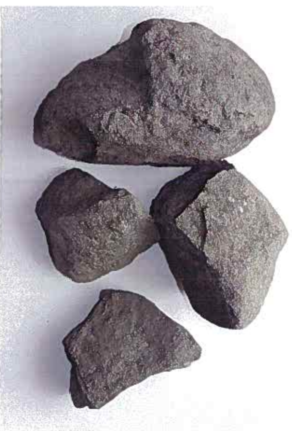
Charakter podložní skalní horniny na vrtu J1 - 7,80 - 8,00 m
