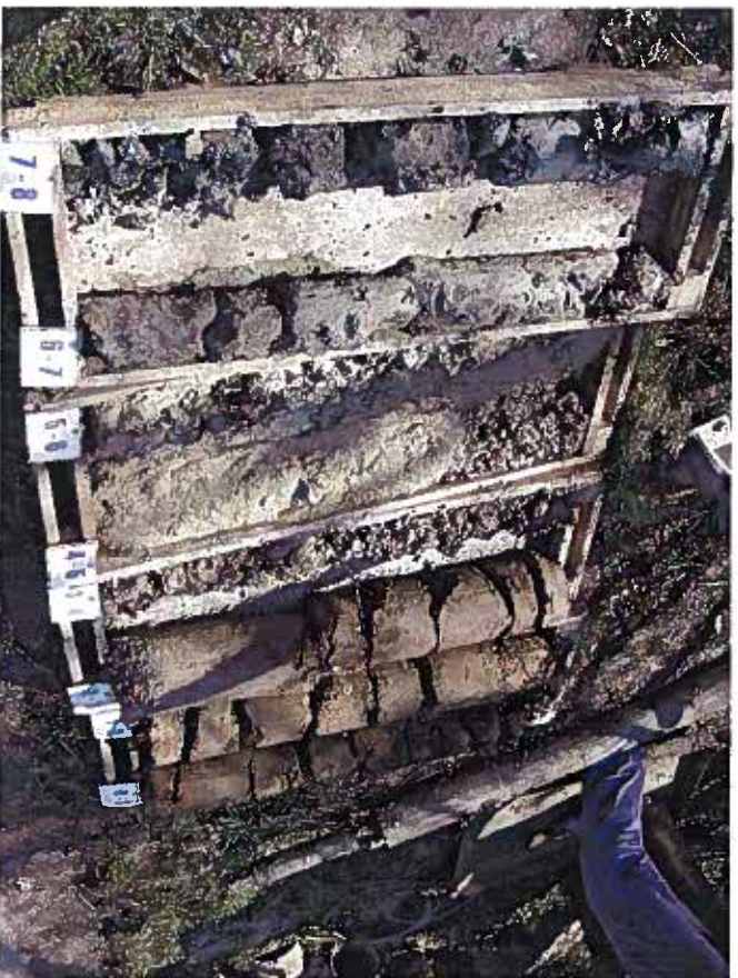
Souvislý vrtný výnos na J1 (8,00 - 0,00 m) - detail spodních vrstev
